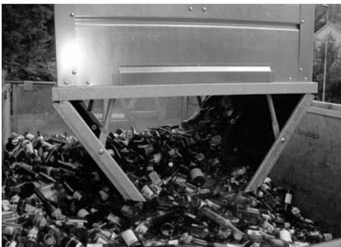
*Entleerung des Containers über die Anhängervorrichtung des Containers*
