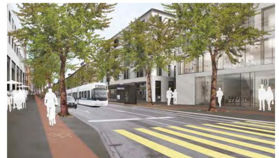
Bild 3: Strassenquerschnitt im Abschnitt Mitte/Ost: Velo- und Fussverkehr im Vorzonenbereich; ÖV und MIV im Mischverkehr, aufgrund der grosszügigeren Platzverhältnisse mit einseitiger Abzweigspur.
