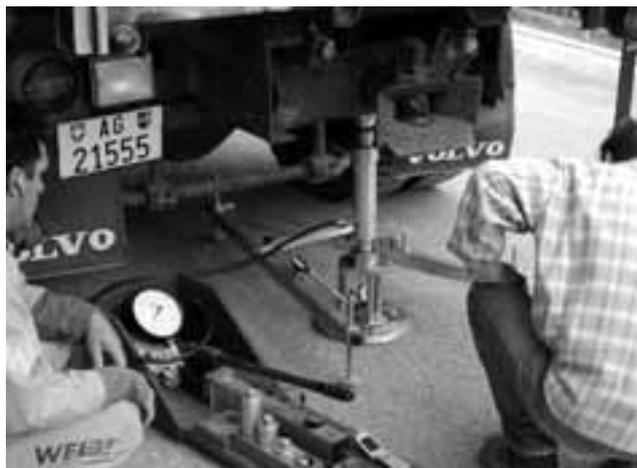
Verdichtungskontrolle der Fundationsschicht (ME-Messung)
