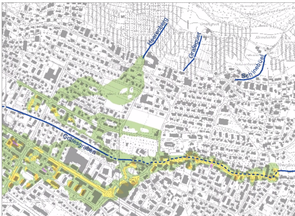
Abb. 5: Kantonale Fliesstiefenkarte HQ300 (nach Massnahmen)
