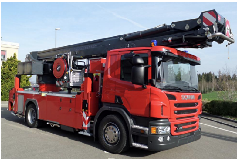
Abb. 1: Mögliches Modell und Beladung eines Höhenrettungsfahrzeuges mit Einzelkabine.
