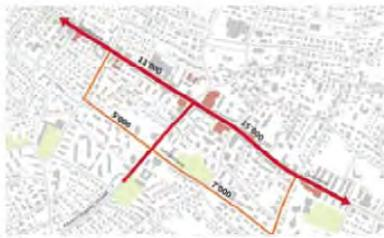
Bild 1: Der Hauptverkehr wird über die Landstrasse abgelenkt (rot). Die Zentralstrasse (orange) ist ergänzende Parallellane.
