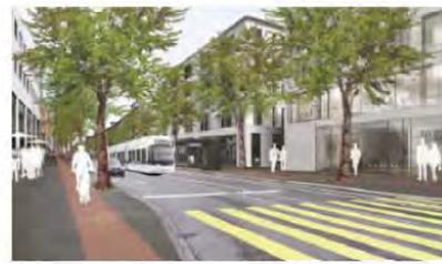
Bild 3: Strassenquerschnitt im Abschnitt Mitte/Ost: Velo- und Fussverkehr im Vorzonenbereich, ÖV und MIV im Mischverkehr, aufgrund der grosszügigeren Platzverhältnisse mit einseitiger Abzweigung.
