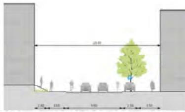
Bild 2: Strassenquerschnitt im Abschnitt West: Trotz engeren Platzverhältnissen haben alle Verkehrsträger ihren eigenen Bereich; Vorzone (z.B. Hochparkeure) mit Fussgängerbereich, Fahrbahn mit Velostreifen, einseitiger Bepflanzung und Längsparkierung.
