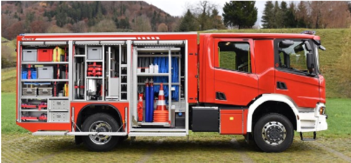
Abb. 2: Mögliches Modell und Beladung eines Pionierfahrzeuges mit Doppelkabine
