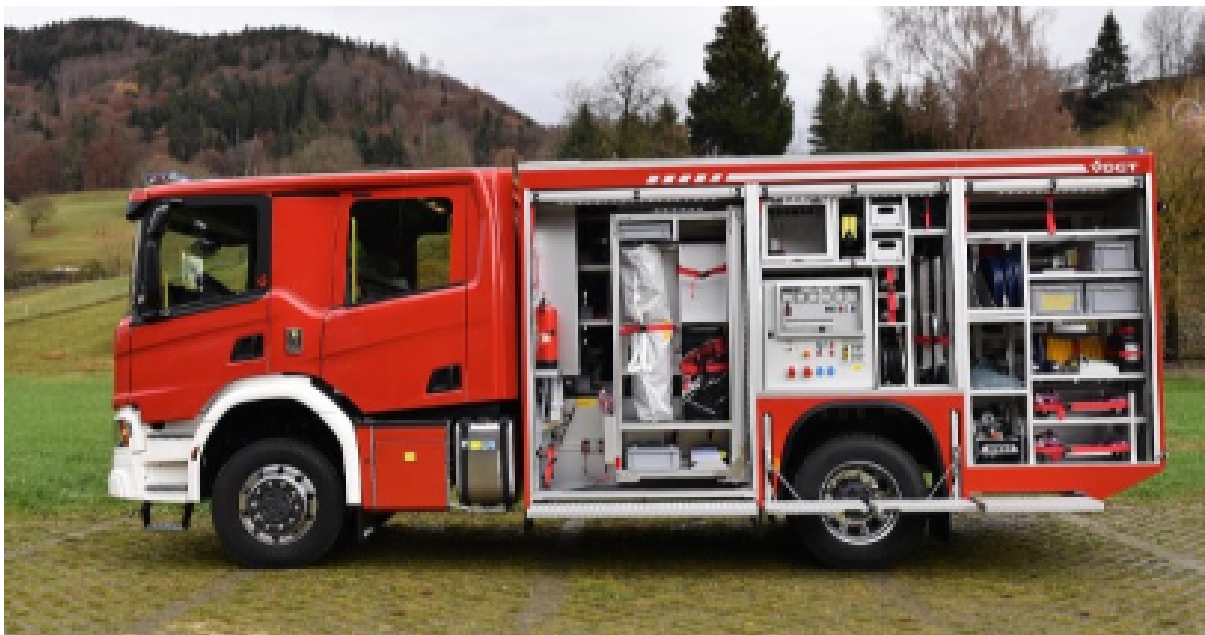
Abb. 3: Mögliches Modell und Beladung eines Pionierfahrzeuges mit Doppelkabine
