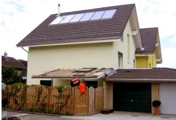
Abb. 3: Die Dachbündigkeit der Solaranlage wirkt integrierend. Die Anlage wird Teil der Gebäudehülle. Beispiel Attenhoferstrasse, Wettingen
